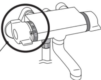
※湯量、水量を調整しているカランの根元の止水栓
